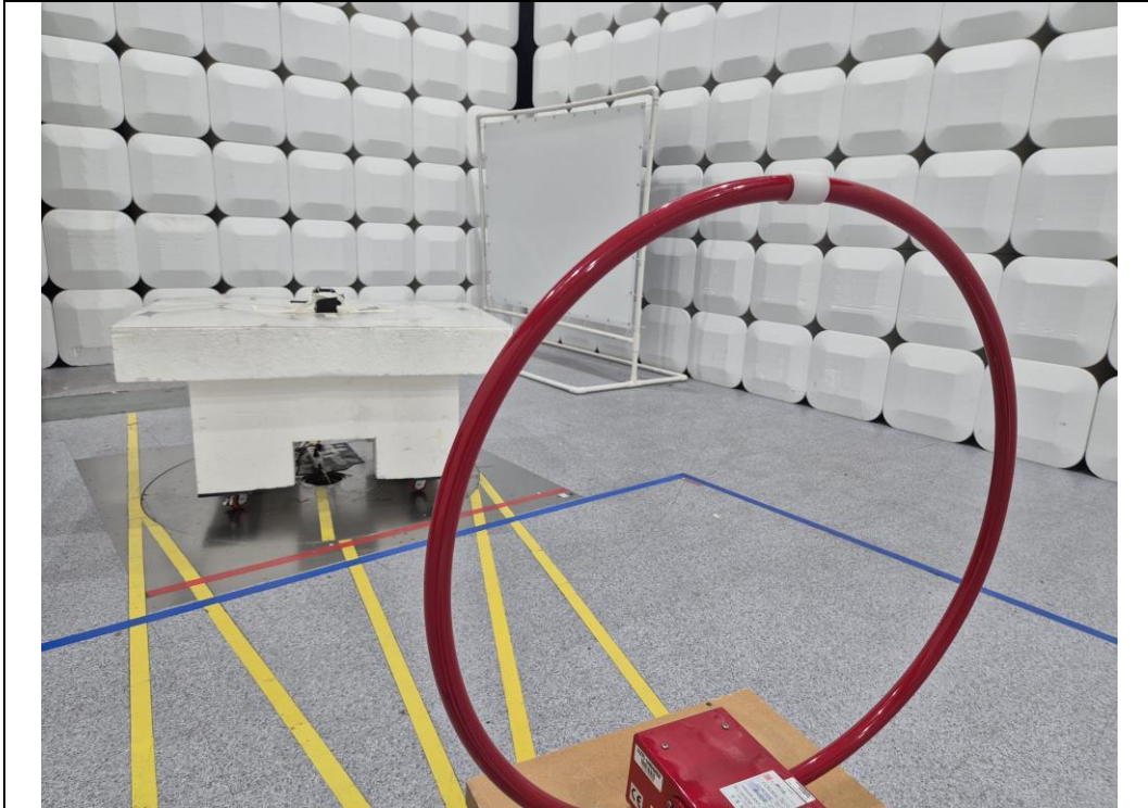
Test distance : 3 m, height of table : 0.8 m
