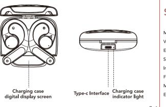
Charging Case Input: 5V 400mA Charging Case Output: 5V 120mA
