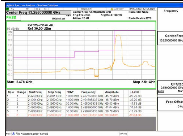
B7 / 15MHz / Low CH / QPSK / 1 RB
