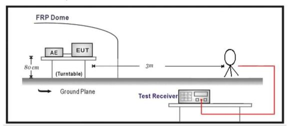
30MHz-1GHz Test Setup:
