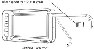
提示:HM702内置有eMMC 256GB储存,无需插入TF卡也能正常工作。未插入TF卡时,视频文件存入eMMC且正常循环录 像;插入TF卡(最大支持512GB)后,视频文件存入TF卡,循环录像时只覆盖TF卡内的文件,当视频被锁定时,该视频会同时 存入TF卡和eMMC(TF卡弹出或接触不良时视频直接录入eMMC)。
