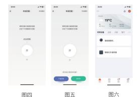
注意:摄像机与受控制的红外电器距离不能超过4米, 否则信号减弱,有可能导致无法控制。
