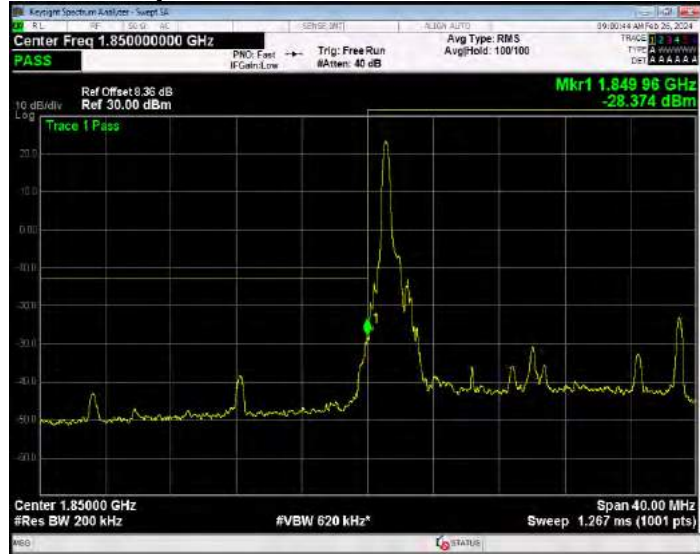
Band2 QPSK BW=20MHz Channel=18700 RB Size=100 Position=#0
