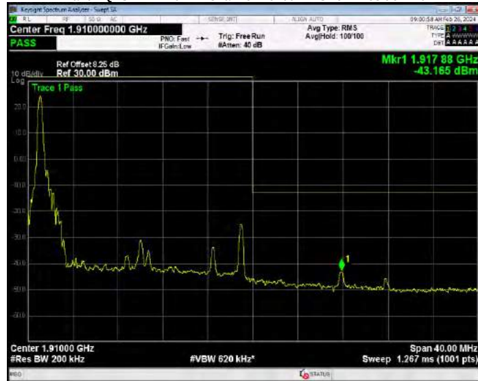
Band2 QPSK BW=20MHz Channel=19100 RB Size=100 Position=#0
