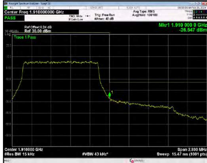
Band2 QPSK BW=10MHz Channel=18650 RB Size=1 Position=#0
