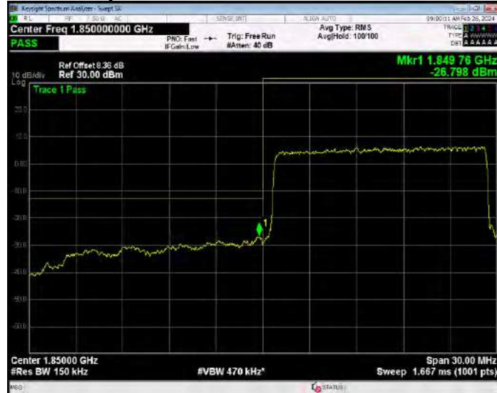
Band2 QPSK BW=15MHz Channel=19125 RB Size=1 Position=#0
