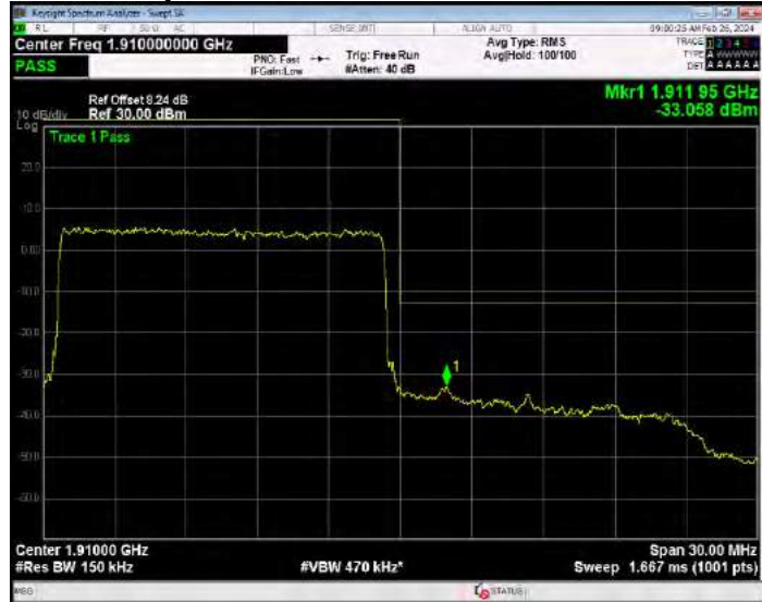
Band2 QPSK BW=20MHz Channel=18700 RB Size=1 Position=#0
