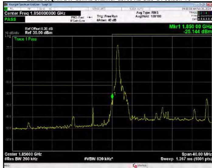
Band2 16QAM BW=20MHz Channel=18700 RB Size=100 Position=#0
