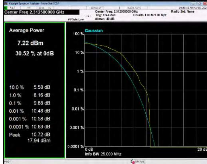
Band40(2305-2315) QPSK BW=10MHz Channel=38750 RB Size=1 Position=#0
