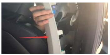
(12).拆下 B 柱上边饰板 用穿线绳将把手线从波纹管穿到车内,线材隐藏在车边沿饰板内
