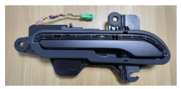
(11).将第二代把手安装到车上插头直接对插原车,用原车螺丝固定好把手即可
