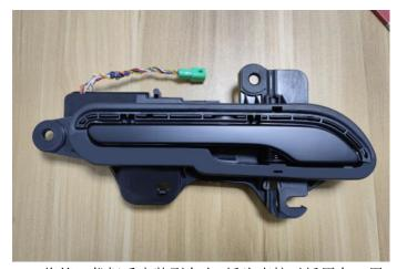
(8).将第二代把手安装到车上 插头直接对插原车,用原车螺丝固定好把手即可
