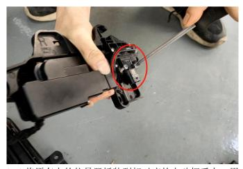
(10).将原车上的信号器拆装到相对应的电动把手上,用 原车螺丝固定
