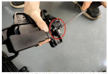
(7).将原车上的信号器拆装到相对应的电动把手上,用原车螺丝固定
