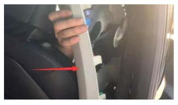
(9).拆下 B 柱上边饰板 用穿线绳将把手线从波纹管穿到车内,线材隐藏在车边沿饰板内
