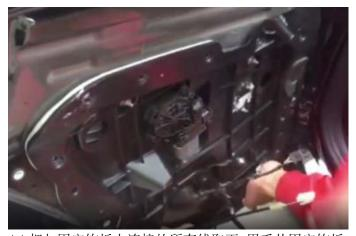
(8).把与固定饰板上连接的所有线取下,用手从固定饰板下端用力往上提的同时 往外拉出即可取下饰板
