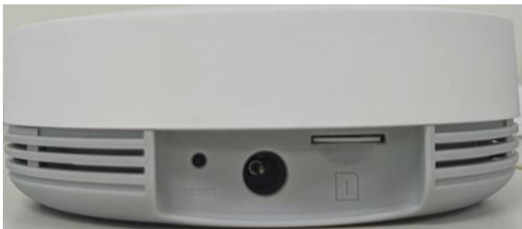
**Reset hole : reset button hole**
