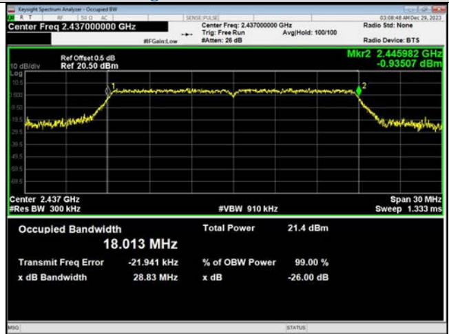
IEEE 802.11n_Channel 6_20MHz_Antenna 1
