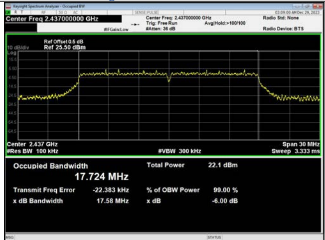
IEEE 802.11n_Channel 6_20MHz_Antenna 1
