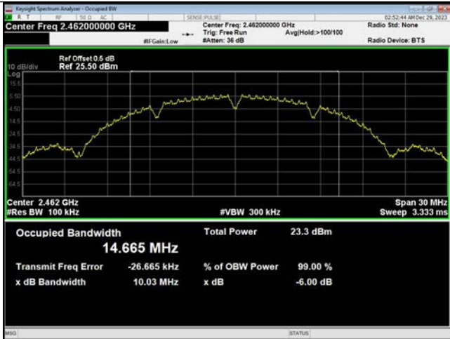
IEEE 802.11b_Channel 11_20MHz_Antenna 1
