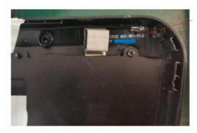
WIFI天线位置,天线露铜区域需要放足 够高的导电泡棉和屏铁框接触。
