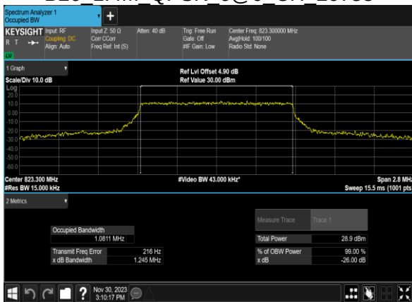
B26 1.4M QPSK 6@0 CH 26783
