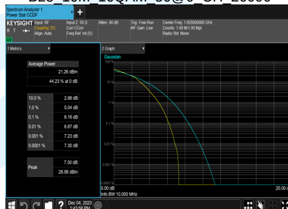
B25_10M 16QAM 50@0 CH 26365
