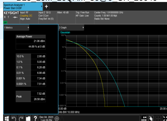
B25_10M 16QAM 50@0 CH 26640
