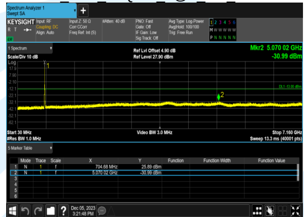
B17 5M 16QAM 1@0 CH 23755
