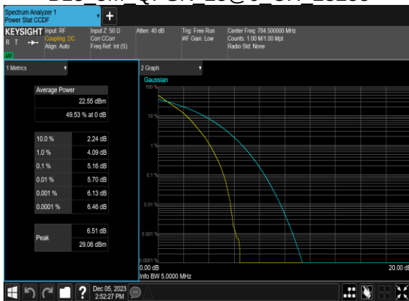
B13 5M QPSK 25@0 CH 23255
