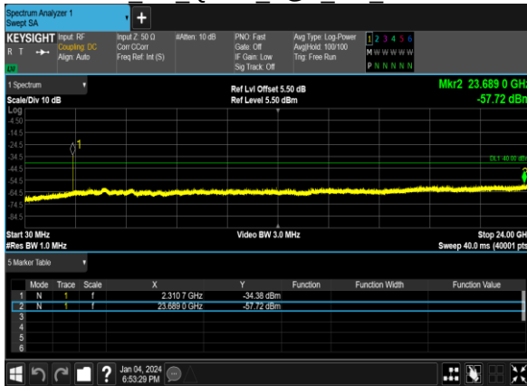
B40 5M QPSK 1@0 CH 38775
