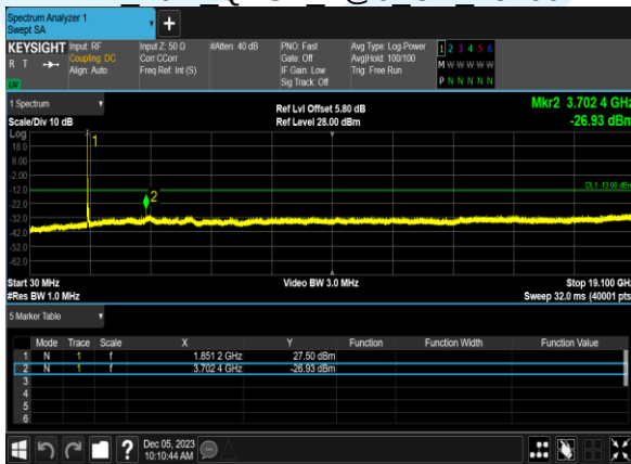
B2 20M QPSK 1@0 CH 18700
