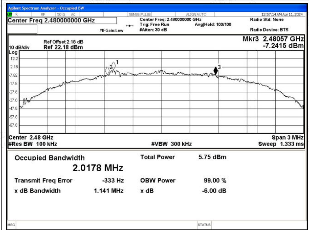
-6dB Bandwidth NVNT BLE 2M 2480MHz Ant1
