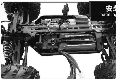
安装车壳支柱 Installing the shell struts
