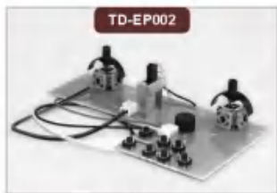
发射板(2.4GHz) Transmitting board(2.4GHz)
