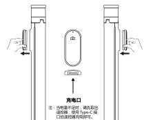
取出運控器 安装遥控器 遥控器采用磁铁吸附,向外取出即可,装回时只需 对准槽位,即可自动吸附。
