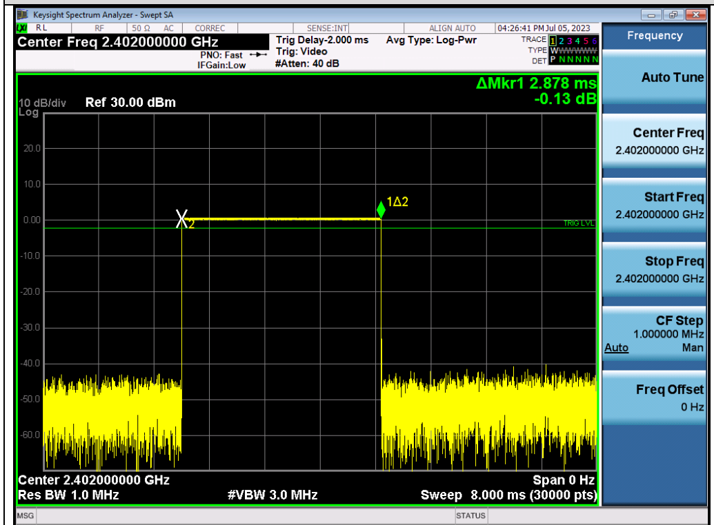
Test_Graph_BR_HOP_ANT1_NA_1Mbps_2402_Time per Burst
