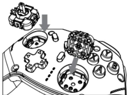
\*注意！安装时，请将摇杆与固定座金属触点的位置一一对应，再将一端卡扣好，最后卡另一端卡扣。
