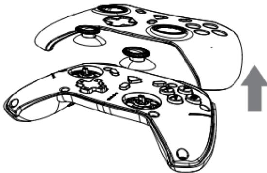
2、使用摇杆拔插器，对准摇杆固定的卡扣位置，将摇杆夹起；
