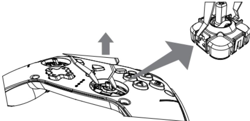
3、根据使用习惯选择对应力度的摇杆装入手柄，听到“咔”的声音，表示摇杆成功安装在手柄上；
