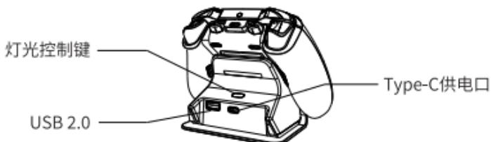
\*单击灯光控制键切换灯光模式，长按灯光控制键可无极调节灯光亮度
