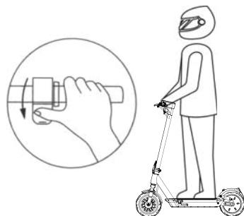
3. Cuando el scooter empiece a avanzar por inercia, ponga los dos pies en la plataforma y pise el acelerador (el acelerador se pone en marcha cuando la velocidad de avance por inercia supera las 3 mph)
