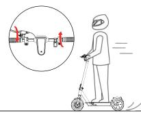
4. Suelta el acelerador y el sistema de recuperación de energía cinética (KERS) se pone en marcha automáticamente para frenar lentamente; y aprieta la palanca de freno para frenar de golpe.
