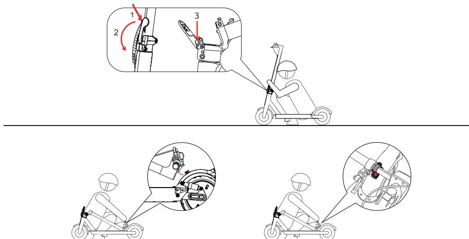
Assurez-vous que le scooter est éteint. Pour plier, déverrouillez le mécanisme de pliage, et pliez la tige du guidon pour accrocher la boucle sur le garde-boue arrière. Pour ouvrir, appuyez sur la gâchette de la cloche pour la retirer de la boucle, redressez le guidon et verrouillez la structure de pliage.
