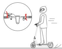
4. Relâchez l'accélérateur et le système de récupération de l'énergie cinétique (KERS) s'enclenche automatiquement pour freiner lentement ; et serrez le levier de frein pour une pour un freinage brusque.
