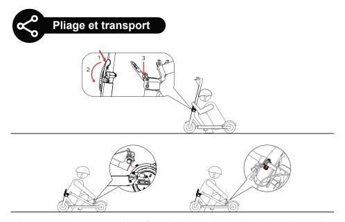
Assurez-vous que le scooter est éteint. Pour plier, déverrouillez le mécanisme de pliage, et pliez la tige du guidon pour accrocher la boucle sur le garde-boue arrière. Pour ouvrir, appuyez sur la gâchette de la cloche pour la retirer de la boucle, redressez le guidon et verrouillez la structure de pliage.
