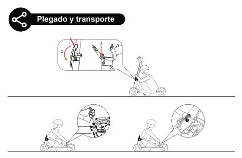
Asegúrese de que el scooter está apagado. Para plegarlo, desbloquee el mecanismo de plegado y doble la potencia del manillar para enganchar la hebilla en el guardabarros trasero. Para abrirlo, pulse el gatillo de la campana para sacarlo de la hebilla, levante el manillar y bloquee la estructura de plegado.
