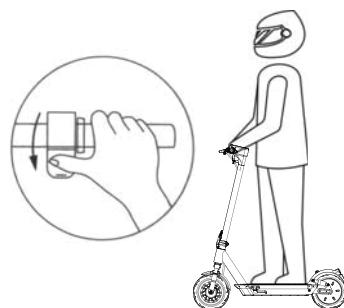
3. Lorsque le scooter commence à rouler en roue libre, posez les deux pieds sur le plancher et appuyez sur l'accélérateur (l'accélérateur se déclenche lorsque la vitesse en roue libre dépasse 3 mph).
