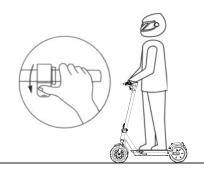
3. Lorsque le scooter commence à rouler en roue libre, posez les deux pieds sur le plancher et appuyez sur l'accélérateur (l'accélérateur se déclenche lorsque la vitesse en roue libre dépasse 3 mph).
