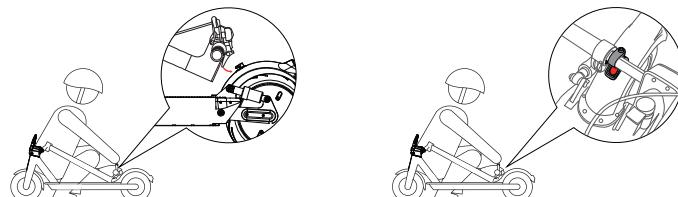
Asegúrese de que el scooter está apagado. Para plegarlo, desbloquee el mecanismo de plegado y doble la potencia del manillar para enganchar la hebilla en el guardabarros trasero. Para abrirlo, pulse el gatillo de la campana para sacarlo de la hebilla, levante el manillar y bloquee la estructura de plegado.
