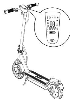
1. Mettez l'appareil sous tension et vérifiez l'indicateur d'électricité.
