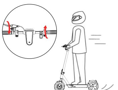
4. Suelta el acelerador y el sistema de recuperación de energía cinética (KERS) se pone en marcha automáticamente para frenar lentamente; y aprieta la palanca de freno para frenar de golpe.
