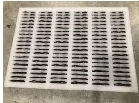
图 2: 统一方向线头朝上整齐排放入盘中
