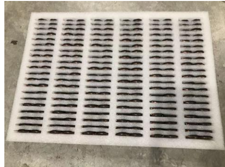
图 2: 统一方向线头朝上整齐排放入盘中
