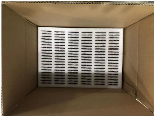
图 3: 放入包装箱, 每箱放置 10 层
