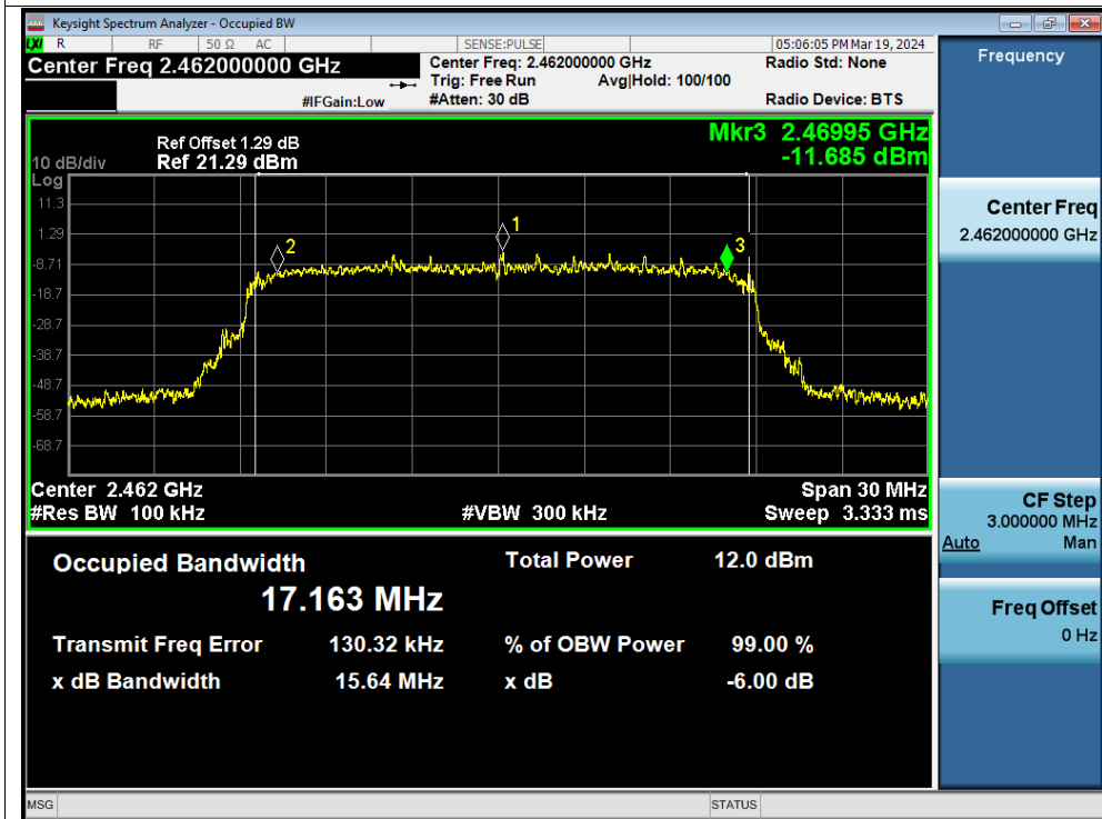
-6dB Bandwidth NVNT g 2462MHz Ant1
