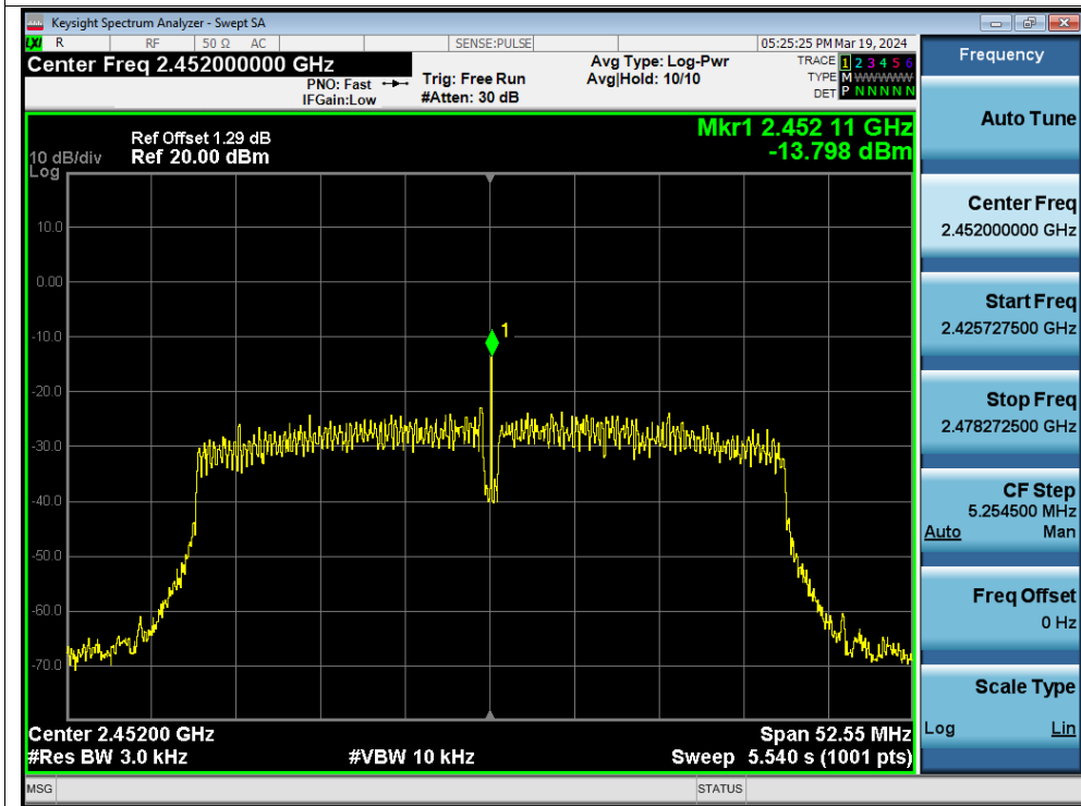
PSD NVNT n40 2452MHz Ant1
