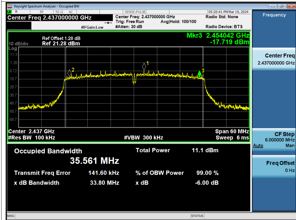
-6dB Bandwidth NVNT n40 2452MHz Ant1
