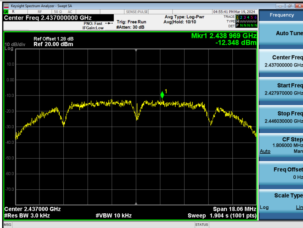
PSD NVNT b 2437MHz Ant1
