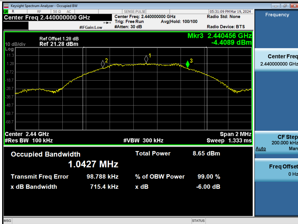
-6dB Bandwidth NVNT BLE 1M 2440MHz Ant1
