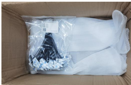
图 2: 装箱 PE 袋周围泡棉包住保护
