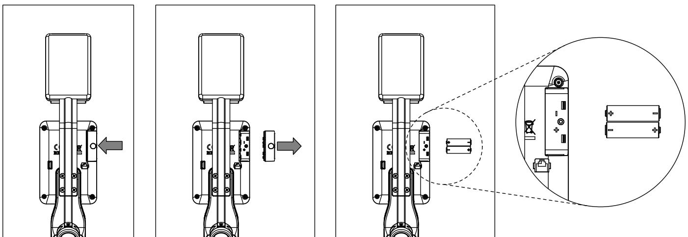
Bei schwacher oder erloschener Computeranzeige muss die Batterie gewechselt werden. Der Computer ist mit vier Batterien ausgestattet. Nehmen Sie den Batteriewechsel wie folgt vor:
