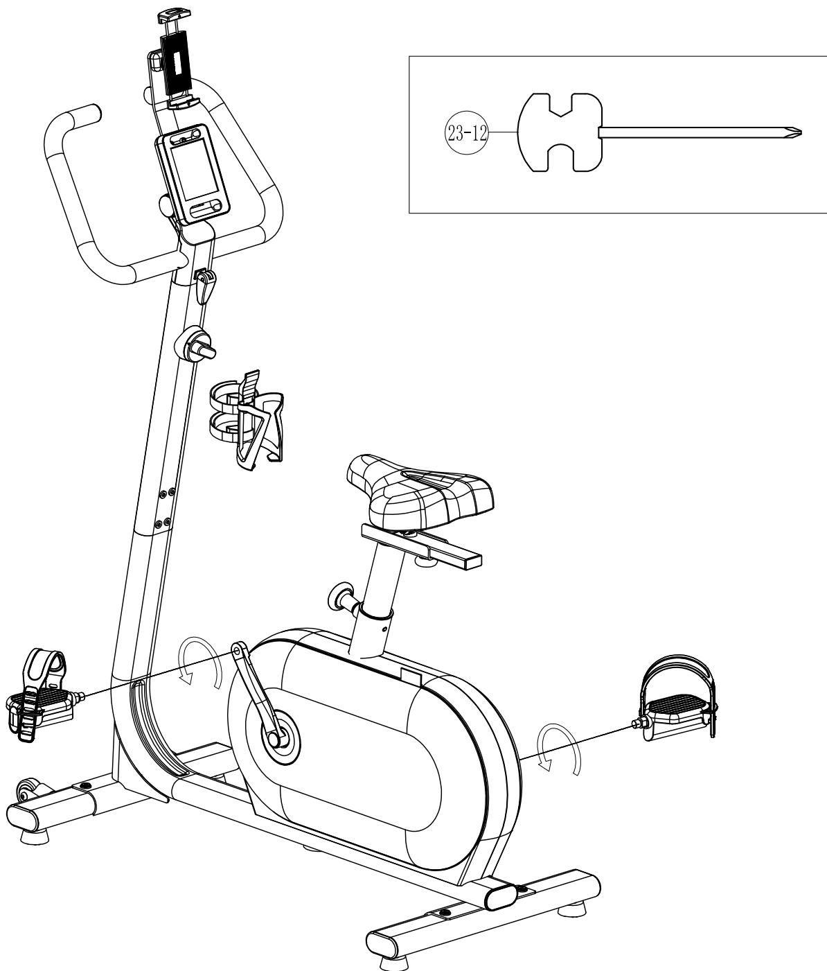
**DE Pedale an die Pedalarme montieren.**
