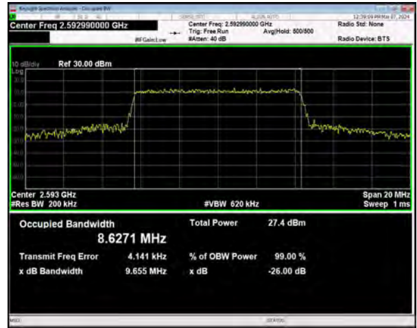
n41 SCS=30kHz CP_QPSK BW=10MHz Channel=518598 RB=24@0
