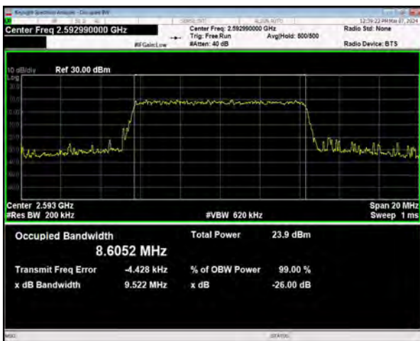
n41 SCS=30kHz CP_256QAM BW=10MHz Channel=518598 RB=24@0
