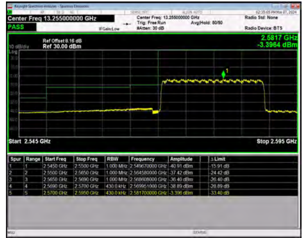
n38 SCS=30kHz DFT_16QAM BW=20MHz LowChannel=516000 RB=50@0
