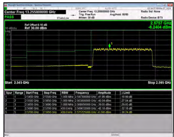
n38 SCS=30kHz DFT_256QAM BW=20MHz LowChannel=516000 RB=50@0
