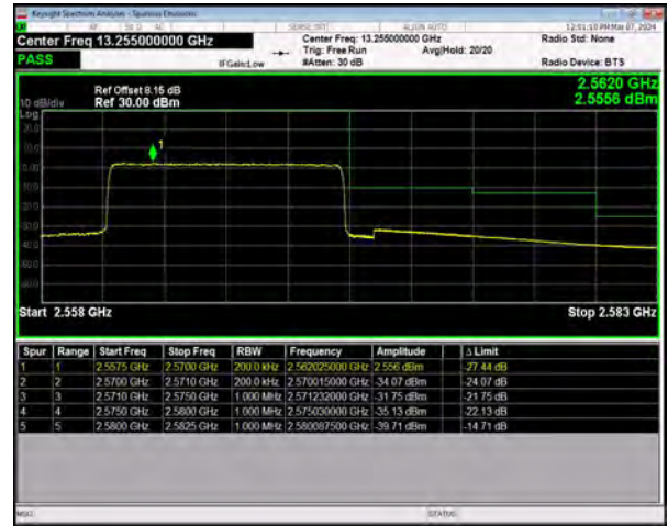
n7 SCS=15kHz CP_QPSK BW=10MHz HighChannel=513000 RB=52@0
