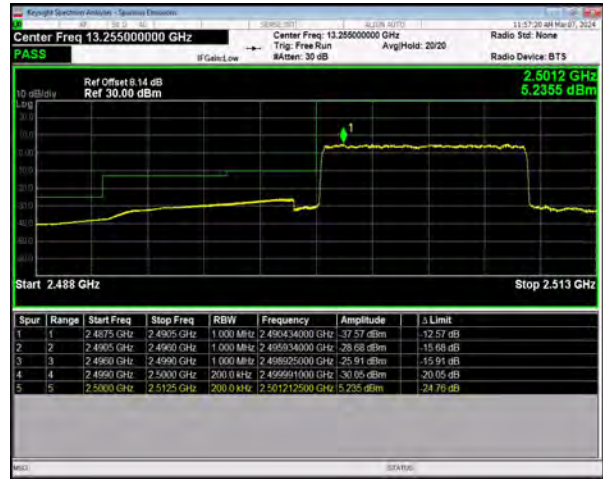
n7 SCS=15kHz DFT_QPSK BW=10MHz LowChannel=501000 RB=50@0
