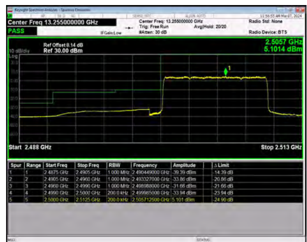
n7 SCS=15kHz DFT_BPSK BW=10MHz LowChannel=501000 RB=50@0
