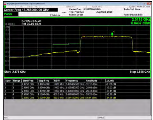
n7 SCS=15kHz DFT_QPSK BW=20MHz LowChannel=502000 RB=100@0
