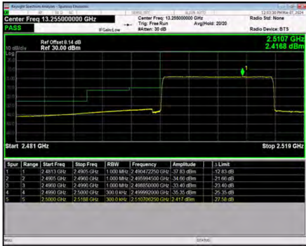
n7 SCS=15kHz CP_QPSK BW=15MHz LowChannel=501500 RB=79@0
