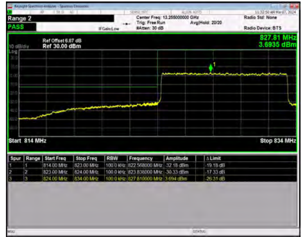
n5 SCS=15kHz DFT_QPSK BW=10MHz LowChannel=165800 RB=50@0
