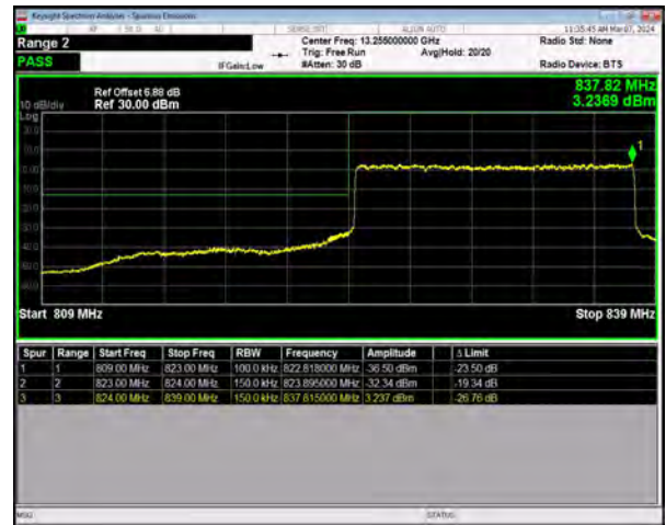
n5 SCS=15kHz DFT_BPSK BW=15MHz LowChannel=166300 RB=75@0
