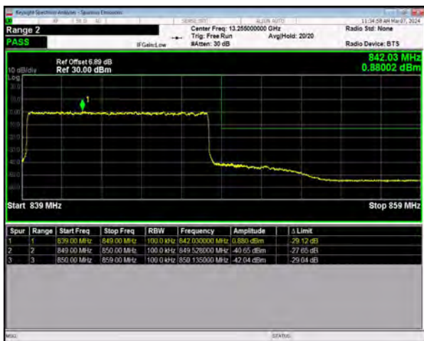
n5 SCS=15kHz DFT_64QAM BW=10MHz HighChannel=168800 RB=50@0
