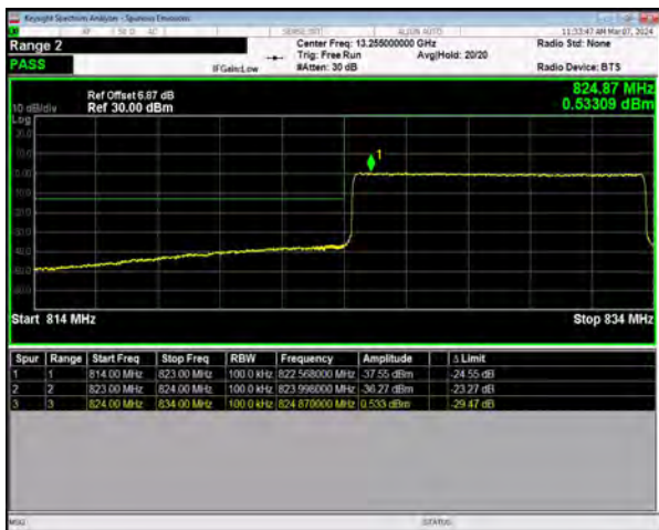
n5 SCS=15kHz CP_QPSK BW=10MHz LowChannel=165800 RB=52@0
