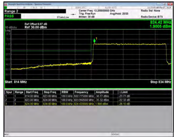
n5 SCS=15kHz DFT_16QAM BW=10MHz LowChannel=165800 RB=50@0
