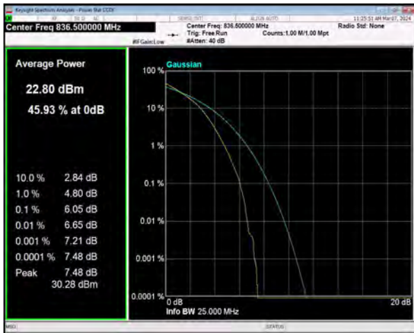
n5 SCS=15kHz DFT_16QAM BW=20MHz Channel=167300 RB=100@0
