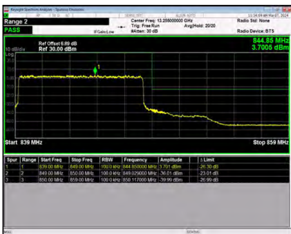
n5 SCS=15kHz DFT_BPSK BW=10MHz HighChannel=168800 RB=50@0
