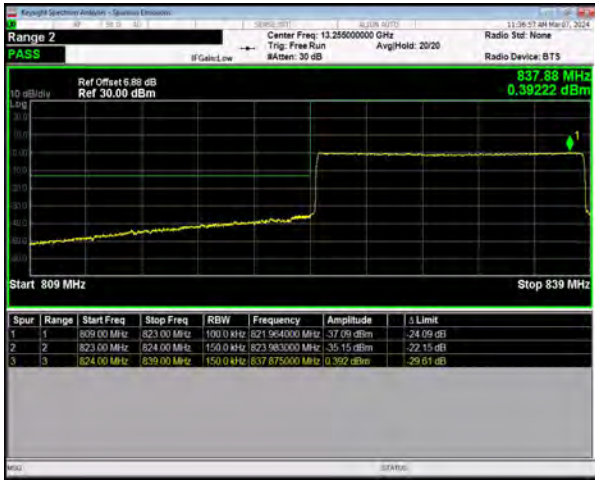
n5 SCS=15kHz CP_QPSK BW=15MHz LowChannel=166300 RB=79@0
