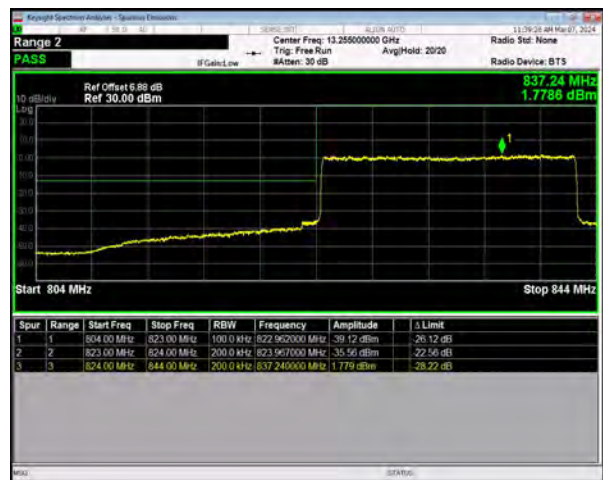
n5 SCS=15kHz DFT_16QAM BW=20MHz LowChannel=166800 RB=100@0
