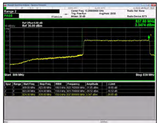
n5 SCS=15kHz DFT_QPSK BW=15MHz LowChannel=166300 RB=75@0
