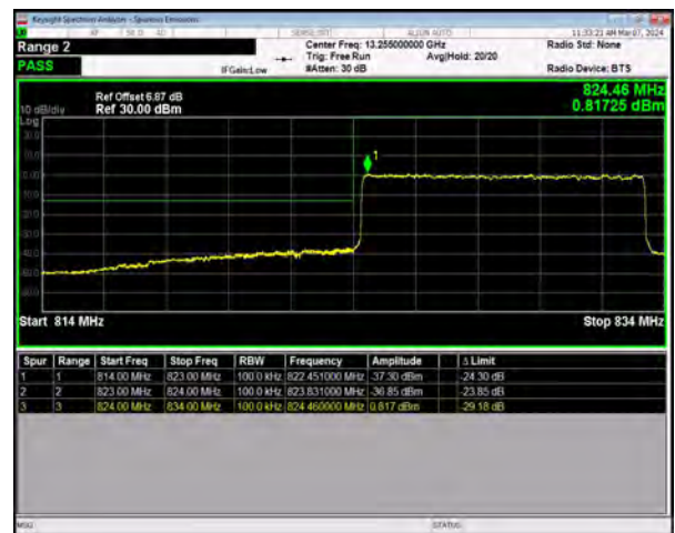
n5 SCS=15kHz DFT_64QAM BW=10MHz LowChannel=165800 RB=50@0
