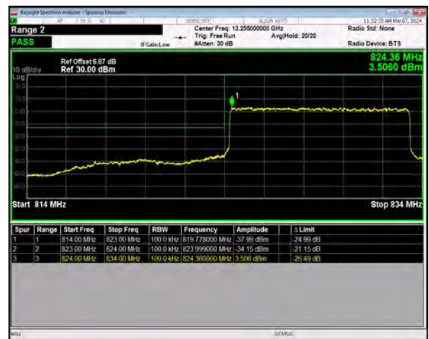
n5 SCS=15kHz DFT_BPSK BW=10MHz LowChannel=165800 RB=50@0
