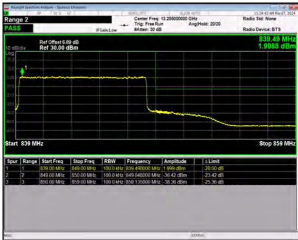
n5 SCS=15kHz DFT_16QAM BW=10MHz HighChannel=168800 RB=50@0
