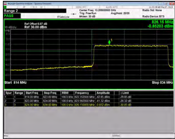
n5 SCS=15kHz DFT_256QAM BW=10MHz LowChannel=165800 RB=50@0
