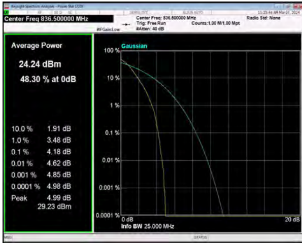
n5 SCS=15kHz DFT_BPSK BW=20MHz Channel=167300 RB=100@0
