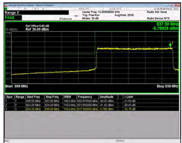
n5 SCS=15kHz DFT_256QAM BW=15MHz LowChannel=166300 RB=75@0
