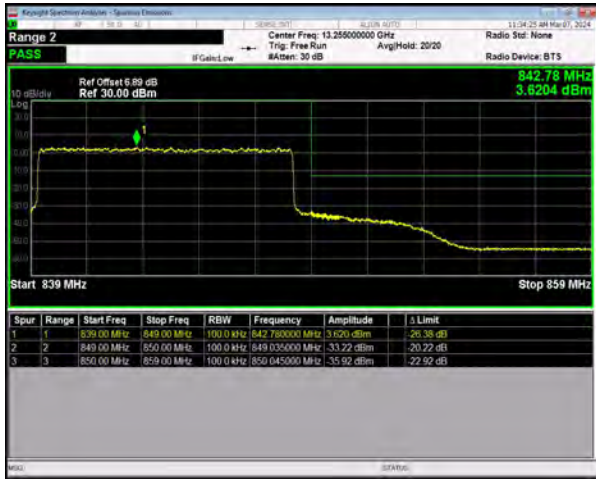
n5 SCS=15kHz DFT_QPSK BW=10MHz HighChannel=168800 RB=50@0
