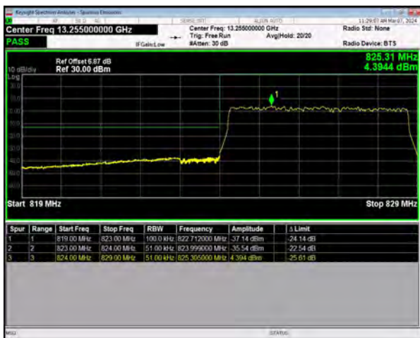
n5 SCS=15kHz CP_QPSK BW=5MHz LowChannel=165300 RB=25@0
