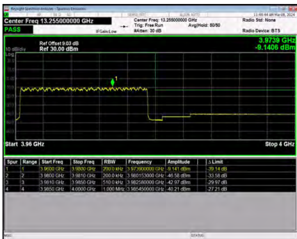
n77(3700-3980) SCS=30kHz DFT_256QAM BW=20MHz HighChannel=664666 RB=50@0
