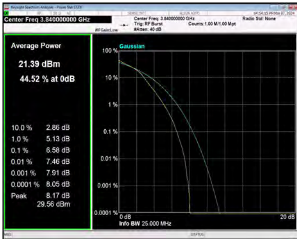
n77(3700-3980) SCS=30kHz DFT_16QAM BW=20MHz Channel=656000 RB=50@0
