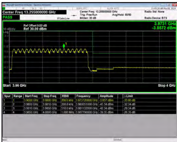
n77(3700-3980) SCS=30kHz DFT_BPSK BW=20MHz HighChannel=664666 RB=50@0
