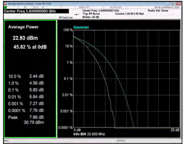
n77(3700-3980) SCS=30kHz DFT_QPSK BW=20MHz Channel=656000 RB=50@0
