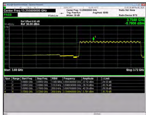
n77(3700-3980) SCS=30kHz DFT_QPSK BW=20MHz LowChannel=647334 RB=50@0
