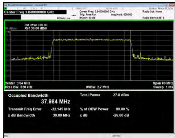
n77(3700-3980) SCS=30kHz CP_16QAM BW=40MHz Channel=656000 RB=106@0
