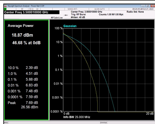
n77(3450-3550) SCS=30kHz DFT_QPSK BW=20MHz Channel=633334 RB=50@0
