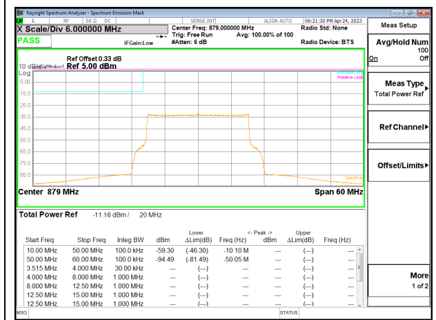
5G NR n5 20MHz QPSK Low Channel
