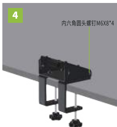
图4：将组装好的桌面支架安装法兰组件通过4颗M6X8内六角圆头螺钉紧固桌面支架下板；
