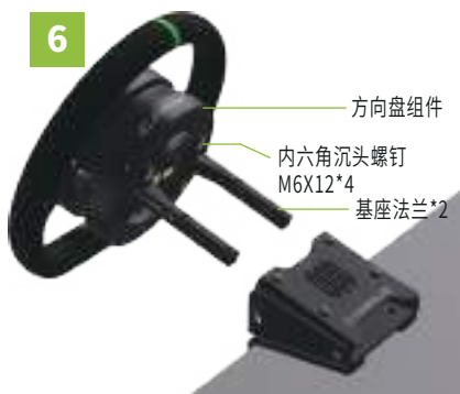
图6：将方向盘整体通过4颗M6X12内六角沉头螺钉与底座法兰进行紧固连接在一起；
