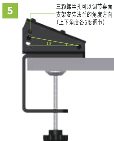
图5：可以通过桌面支架下板的三颗螺丝孔来对桌面支架安装法兰的角度方向进行调节（上下方向各6度角度调节）；
