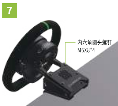
图7：将连接好后的整体方向盘组件通过滑槽插入桌面支架安装法兰上，并通过4颗M6X8内六角螺钉进行紧固连接起来，完成桌面方向盘的安装；
