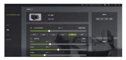
③设备:主要查看、设置各设备工作状态,包括手刹、方向盘、踏板、动态座椅等的设备设置。
