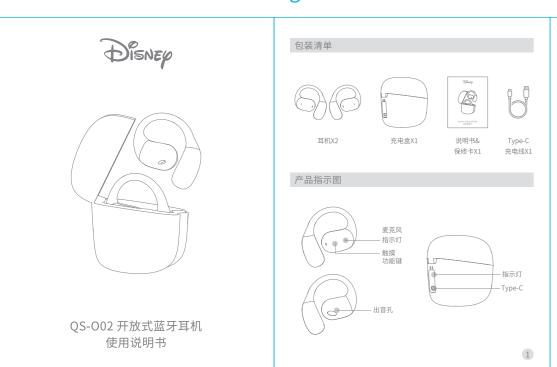
蓝牙版本: V5.4 传输距离: >10米 喇叭直径: φ14.2mm 喇叭阻抗: 32欧 喇叭灵敏度: 110dB ±3dB
