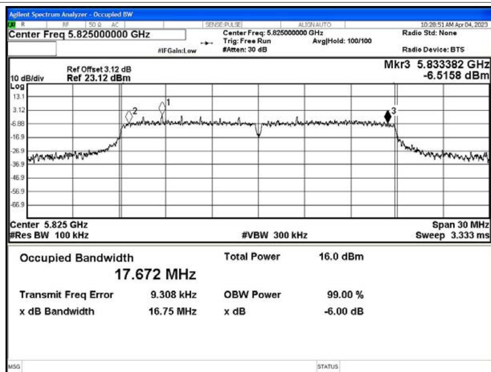
-6dB Bandwidth NVNT ac40 5755MHz Ant1
