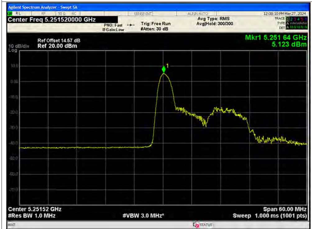
PSD NVNT ax40 26@0 5270MHz Ant1
