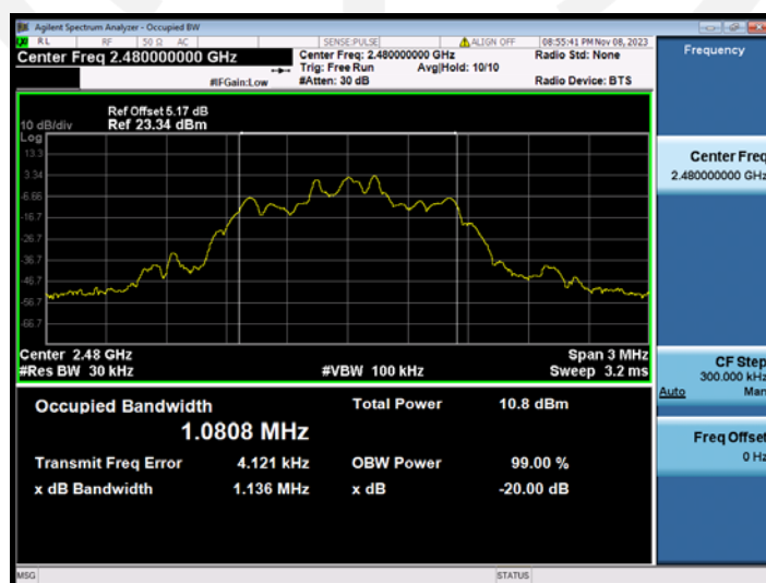
\pi/4 -DQPSK (2-DH1) 2480MHz
