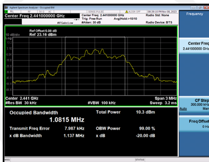
\pi/4 -DQPSK (2-DH1) 2441MHz
