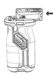
②1/4"-20螺丝安装:拆卸冷靴夹后,通过1/4"-20螺丝将遥控器固定至内置1/4"-20螺纹孔设备上。
