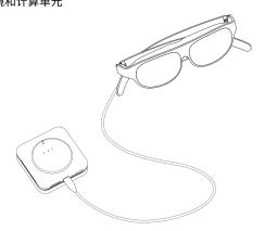
Plug the USB-C cable of the glasses into the Computing Unit. メガネの USB-C ケーブルをコンピューティングユニットに差し込みます。 클래스의 USB-C 타입 케이블을 컨퓨팅 유닛에 꽂아주세요 将眼镜的 USB-C 连接线插入计算单元。
