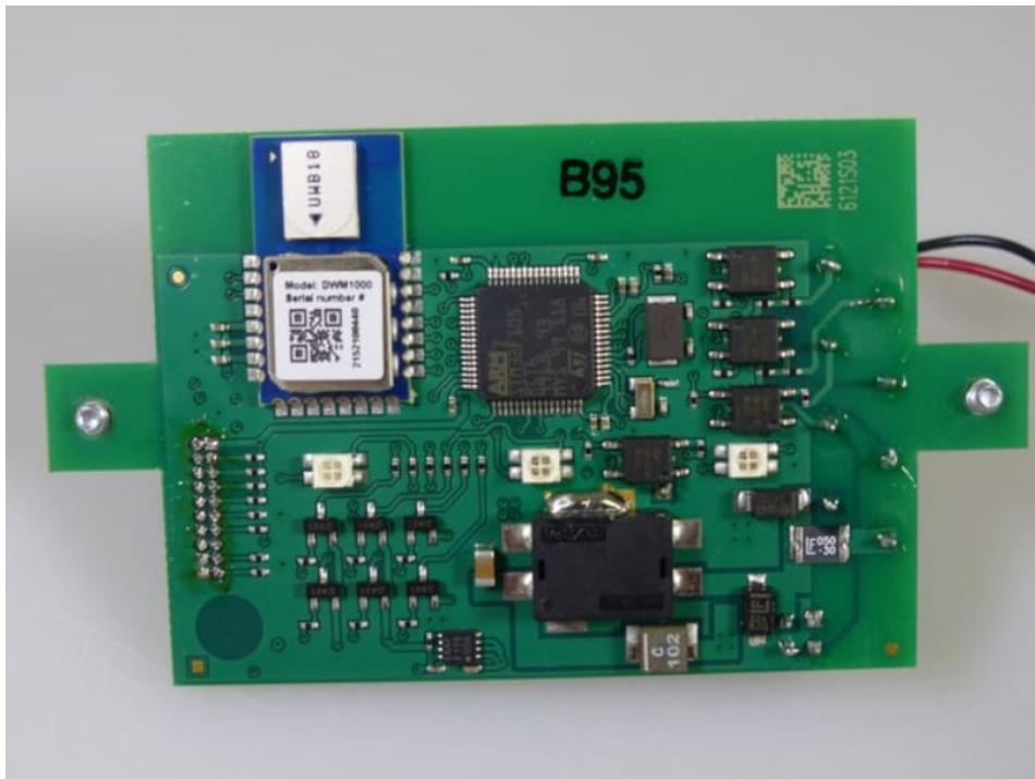
Photo 4: UWB chip DUT
