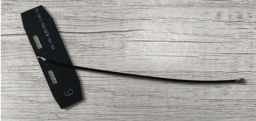
HS-五代 PRO-6#-2.4G 全向天线 PCB 黑色 To IPEX 一代 OD1.37mm 黑色低损线 L120mm
