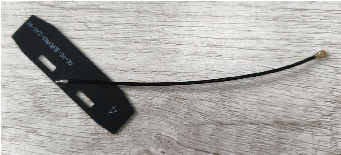
HS-五代 PRO-4#-2.4G 天线 PCB 黑色 To IPEX 一代 OD1.37mm 黑色低损线 L115mm
